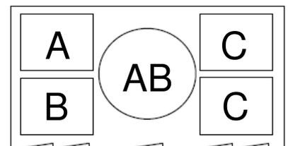
Hvis det valgte varmetrin for begge zoner overstiger maks. ydelse, reducerer power management funktionen automatisk ydelsen på en af disse zoner. Displayet til denne zone blinker først, og varmetrinnet reduceres herefter til højst mulige varmetrin.
