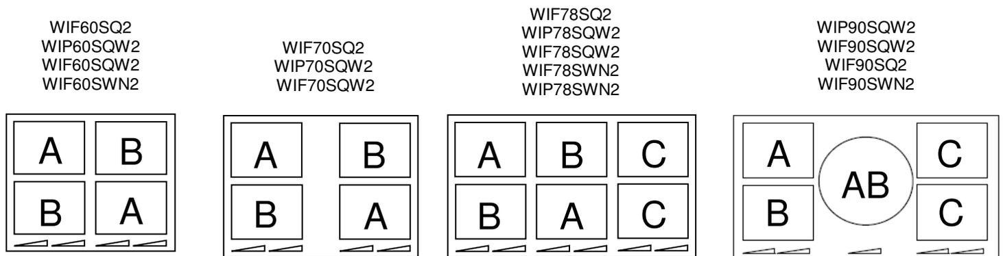
Hvis det valgte varmetrinn for begge soner overstiger maks. Ytelse, reduserer power management-funksjonen automatisk ytelsen på en av disse sonene. Displayet til denne sonen blinker først, og varmetrinnet reduseres så til høyeste mulige varmetrinn.
